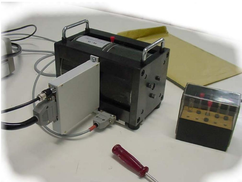
Fig. 3: módulo em que se aplicam os campos magnéticos. A extremidade do tubo que contém a amostra se destaca pela pequena tampa vermelha. À direita, o conjunto de portadores de amostras.
