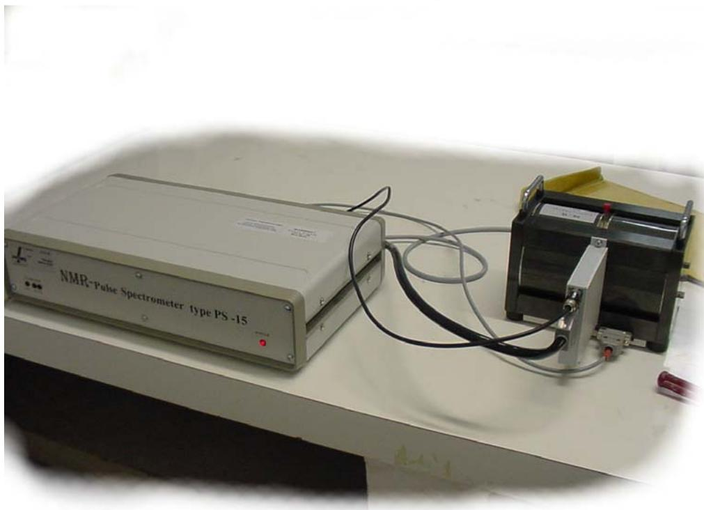
Fig. 5: ligação do amplificador ao conjunto portador da amostra p/ estudo da RMN.
