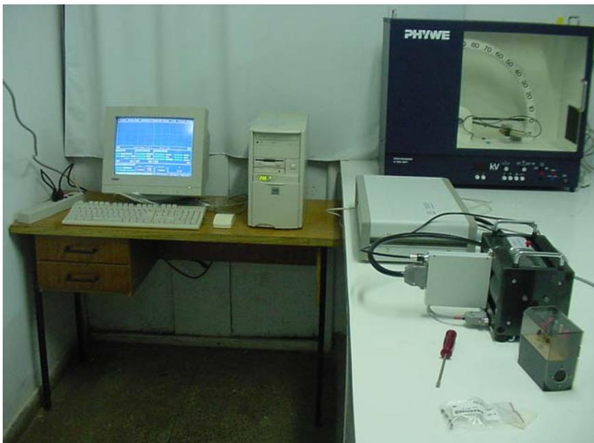
**Fig. 2:** o conjunto está em operação e o monitor do PC mostra o início da varredura. Ao fundo e à direita, temos o conjunto para estudo das propriedades dos Raios X, também instalado na UFES.
