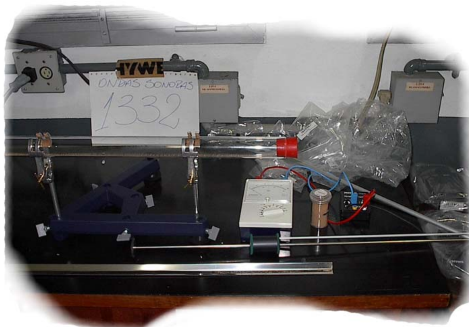
Fig. 1: montagem do tubo de Kundt e os acessórios correspondentes.
