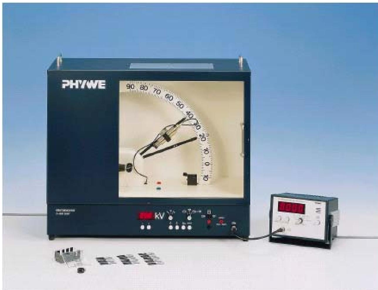
Fig. 1: Montagem experimental para determinação de absorção de raios-X.
