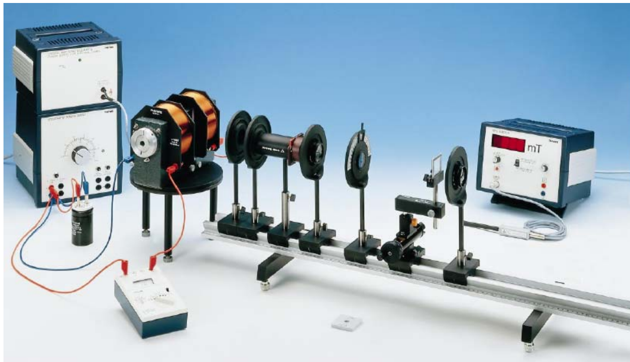
Fig.1: Montagem experimental para o efeito Zeeman. A intensidade do campo magnético pode ser obtida pela curva de calibração das bobinas, ou usando o gaussímetro ilustrado, que deve ser adquirido separadamente.
