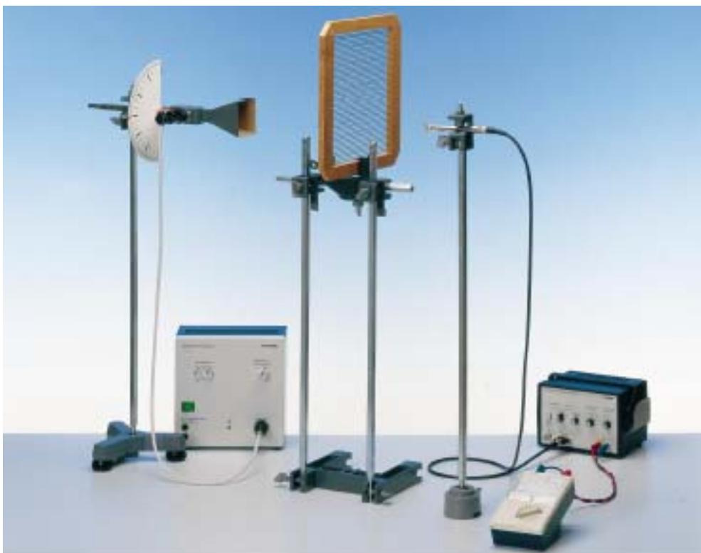
**Fig. 1b: montagem experimental para análise da polarização**
