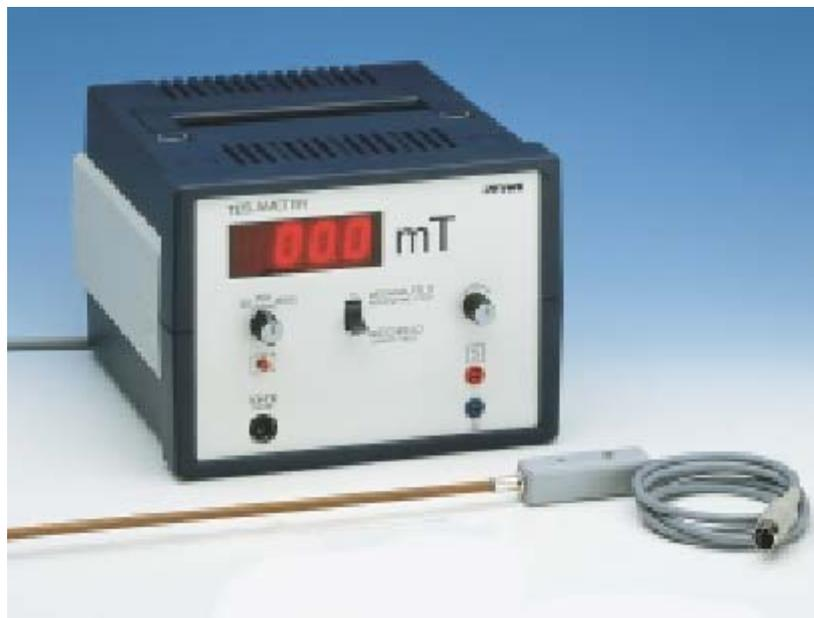
Fig. 1a. Gaussímetro e sonda axial.
