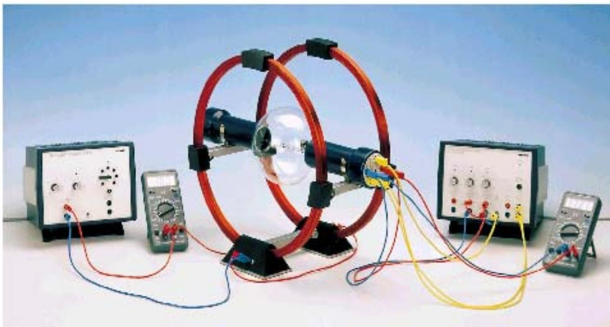
**Fig.1: Montagem experimental para determinação da relação  $e/m$ .**
