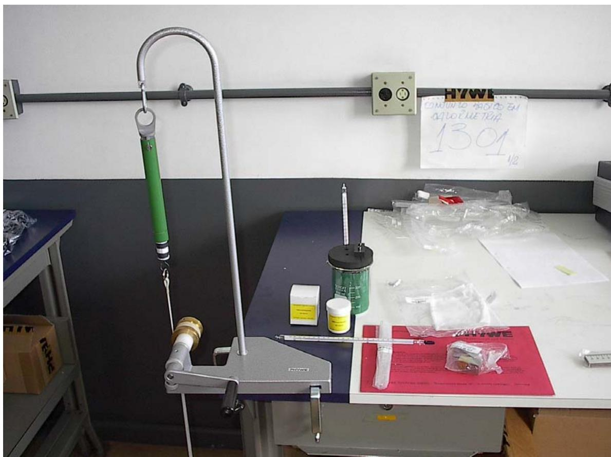
**Fig. 1: Montagem experimental: Equivalente mecânico do calor.**
