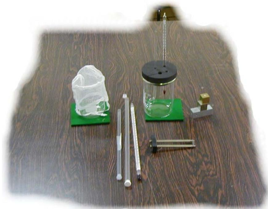
Frascos para mistura de líquidos e verificação das condições de equilíbrio térmico, tampo isolante, termômetros, rede de suporte de amostra, base de feltro isolante e anti-impacto além de pequenos de sólidos metálicos para
