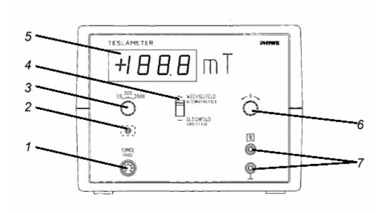
Fig.1 mostra o gaussímetro com os controles e as partes funcionais no painel frontal.
