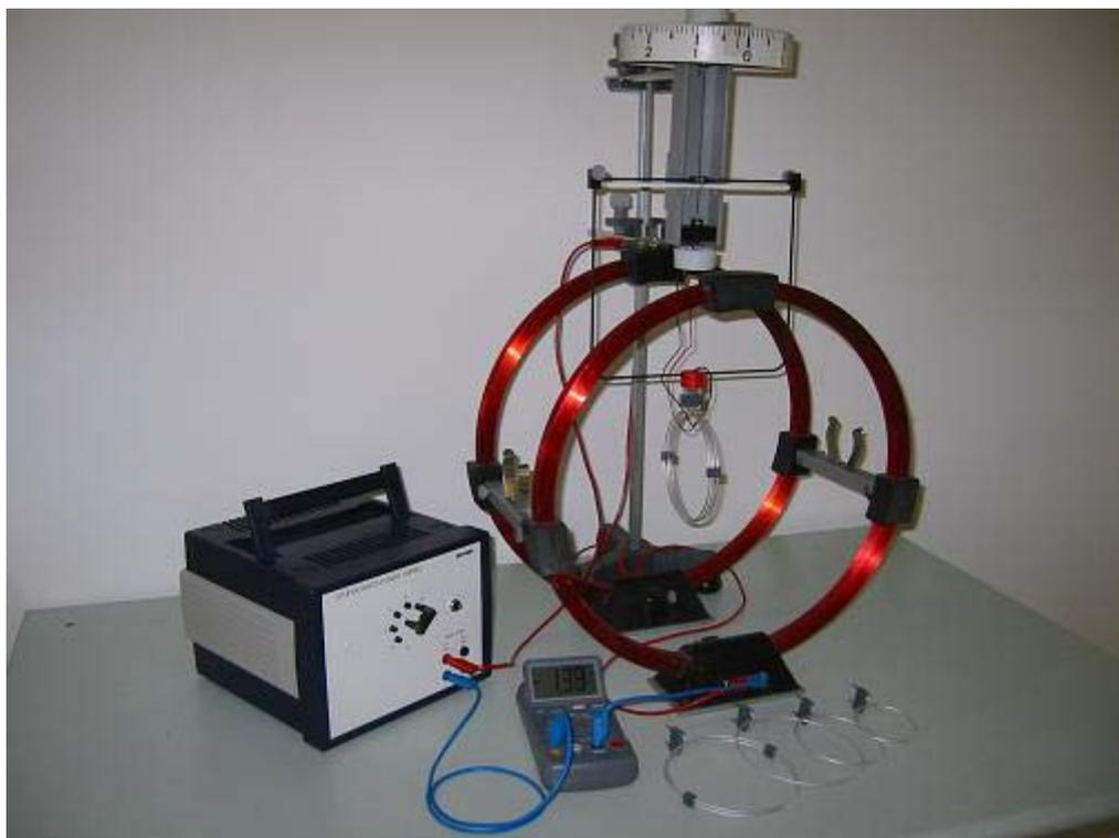
Fig. 8: Montagem experimental para determinar o torque devido ao momento magnético de uma espira imersa em um campo magnético.
