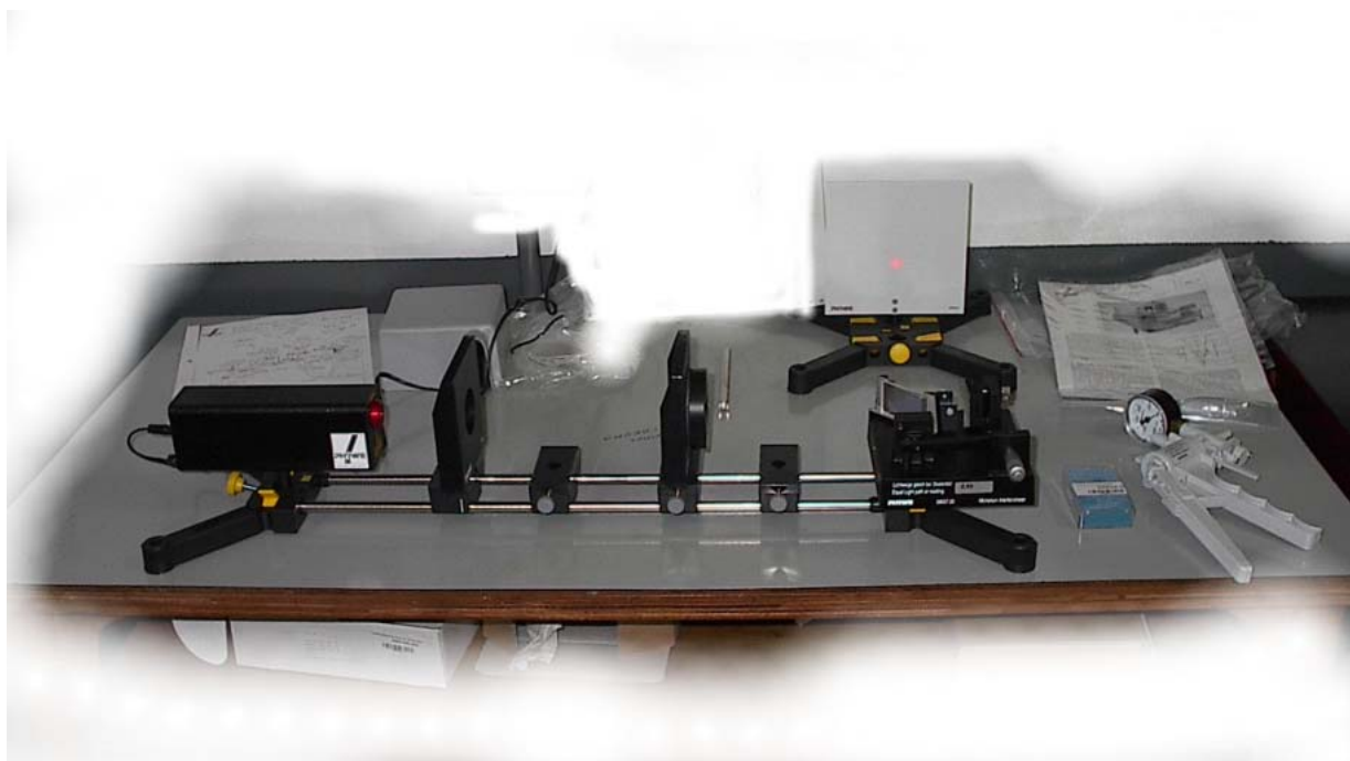
Fig.1: Montagem experimental para interferômetro de Michelson
